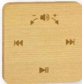
Diese können die Audiofunktionen eines verbundenen Bluetooth-Geräts über den collax Bluetooth-Player steuern. So kann das Bluetooth-Gerät (z.B.: ein Smartphone) außerhalb der Kabine bleiben.
